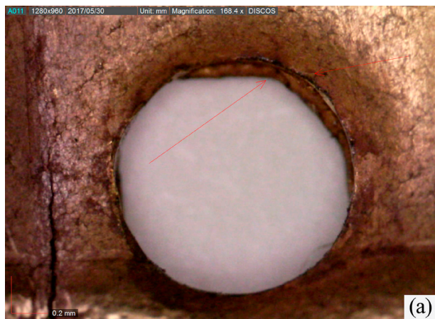
FIG. 22. Huellas de corte en uno de los orificios del disco 03258: a) vista frontal desde el anverso (aum.: 168,4x); b) vista oblicua desde el anverso (aum.: 207,3x).
