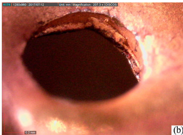
FIG. 22. Huellas de corte en uno de los orificios del disco 03258: a) vista frontal desde el anverso (aum.: 168,4x); b) vista oblicua desde el anverso (aum.: 207,3x).
