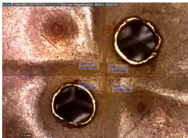
FIG. 13. Medición de los ángulos formados por el diseño del cruciforme desde el reverso de la pieza 03257 (medición bajo binocular; aum.: 60,9x).
