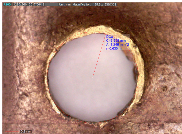
FIG. 21. Restos de rebabas con huellas de pulido en el anverso de la pieza del disco 03257 (aum.: 155,5x).
