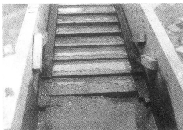
FOT. 2. Canal de lavado de la planta-piloto de R.T.M. en Castrillo de la Valduerna, detalle del material aurífero depositado en el fondo, retenido con la ayuda de los tablones transversales o riffles.
