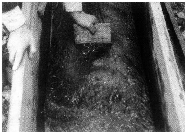
FOT. 3. Recogida del material aurífero depositado en el fondo del sluice de la planta-piloto, de R.T.M.
