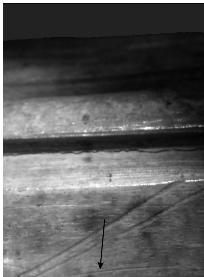
FIG. 4. Líneas de fuga que sobrepasan una marca de corte, ubicada en el margen inferior de la imagen (7,5x, CL-780).
