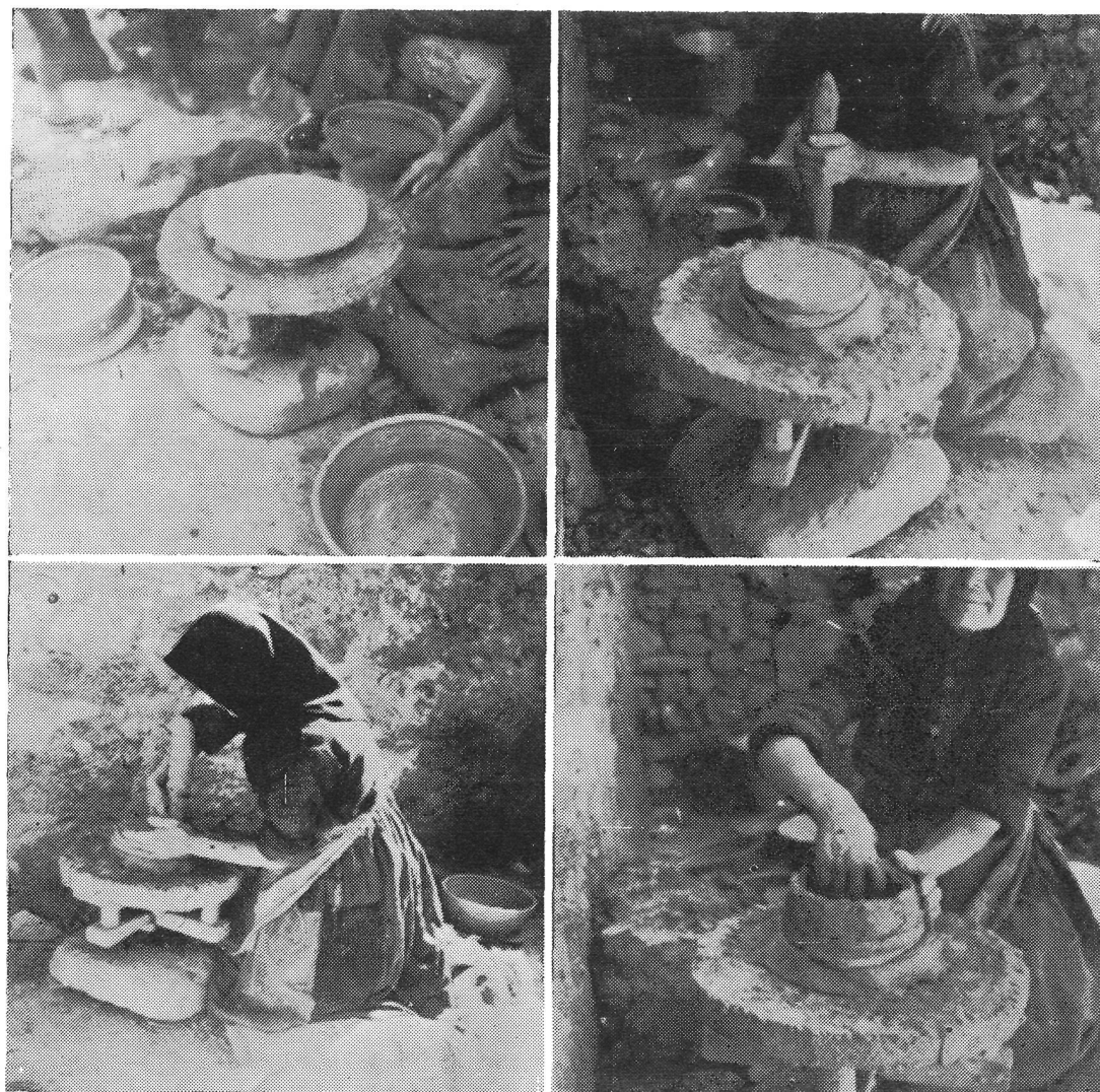
Foto 1: La lusia sobre la maya . Junto al brazo de la alfarera se ve el testero en que ésta se lava las manos, y al pie de la rueda una cazuela ya terminada y levantada de la rueda, pero con la lusia aun adherida al asiento. Foto 2: Asiento de una cazuela acabado sobre la lusia ; la alfarera tiene en sus manos el rollo . Foto 3: La alfarera comienza a pegar el rollo al asiento ya hecho de una cazuela. Foto 4: La alfarera acabando de pegar el rollo al asiento.
