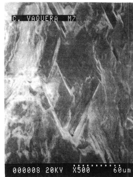
Microfot. 4. Detalle de cristalizaciones de feldespato que presenta la matriz cerámica M-7.
