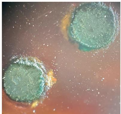
Figura 19. En la microscopía óptica de las varillas en el monel observamos la oxidación metálica en el borde y cómo está afectando a la nitrocelulosa con separación del metal y el polímero. Enosa 45x.
