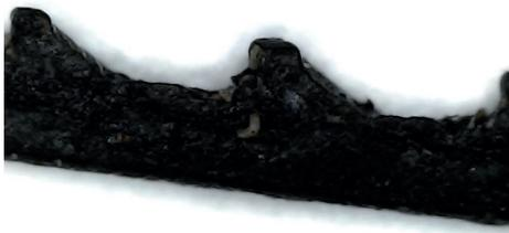
Figura 10. La microscopía digital (60x) del arreglo de la patilla muestra una oxidación total a núcleo de goethita sin presencia de óxido de hierro.
