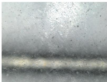
Figura 13. En la microscopía digital (60x) del cristal derecho vemos la manufactura del cristal con la irregularidad por pulido de la superficie que además ha sido colado por la presencia de punteaduras de aire y el *crizzling* en la parte blanquecina.
