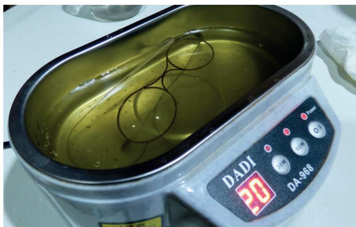
Figura 21. En la imagen se observa la limpieza por ultrasonidos en pila con disolución, comprobándose que gran parte del óxido de hierro ya ha sido removido.
