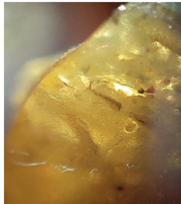
Figura 18. En la microscopía óptica de la patilla que sustituyó a la original podemos ver una textura diferente, una conformación longitudinal del plástico, lo que ha favorecido la fractura y pérdida de soporte. Enosa 45x.
