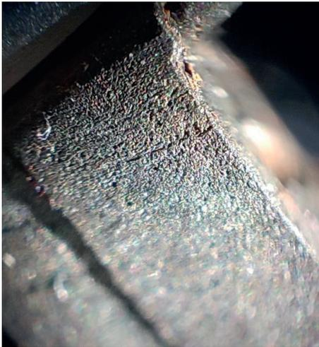
Figura 22. Microscopía óptica (45x) del estado del metal tras la limpieza, la inhibición y el encapsulado con resina acrílica.
