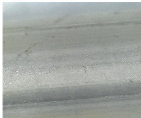
Figura 20. Microscopía digital (60x) del borde del cristal óptico donde se ven las capas y el tallado de este para adaptarlo a la ranura del molde de la gafa.
