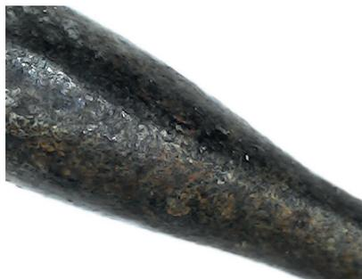
Figura 11. En la microscopía digital (60x) del puente se observa la mineralización del núcleo en zonas anaranjadas circulares y la goethita negra.
