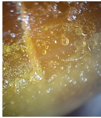
Figura 16. En la microscopía del puente de la gafa podemos ver como las burbujas se hacen más numerosas, el material más opaco y denso por la manufactura por colado y una fisura vertical con distinto color. Enosa 45x.
