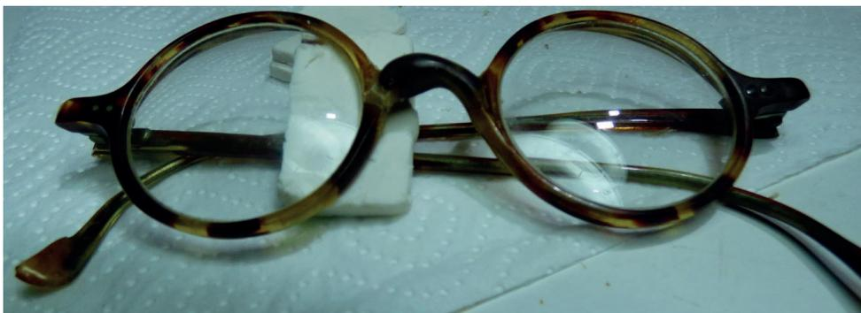
Figura 23. Se han realizado varios test de adhesivos seleccionando la resina nitrocelulósica. Se hicieron test de dureza, contracción de secado y tinción antes de llevar a cabo la unión. Para realizar la adhesión se ha creado una cama de plastilina que mantenga la gafa estable mientras se aplican puntos de unión y se rellena el espacio separado por las escamas con el adhesivo de igual composición que el material original y, por lo tanto, lo más compatible posible.
