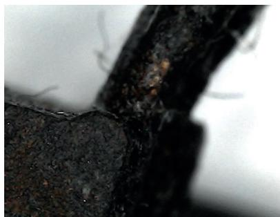
Figura 12. En la microscopía digital (60x) de la bisagra se aprecia que el óxido oculta la totalidad del herraje alterando la superficie lisa.
