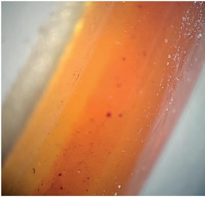
Figura 15. En la microscopía óptica se observa el aro de la gafa con su color anaranjado, la ausencia de burbujas y cambio cromático en punteaduras y veteado. Enosa 45x.
