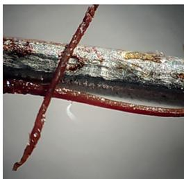
Figura 8. Se observa la microscopía óptica de la varilla encapsulada con plástico y con óxido de hierro III en zonas puntuales. Se puede ver la manufactura del hierro por extrusión. Enosa 45x.
