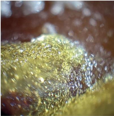
Figura 17. La fractura vista en la microscopía óptica tiene una descamación, en la zona donde las burbujas están en mayor concentración creando una superficie más débil por lo que provocó la fractura. Enosa 45x.
