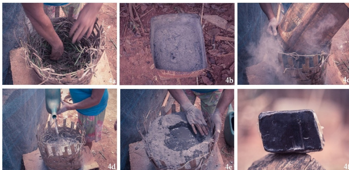
Fig. n.º 4a. Balaio de bambu forrado com capim meloso; 4b. Cinzas provenientes do fogão à lenha; 4c. Cinzas sendo despejada dentro do balaio, formando o barreleiro; 4d. Cinzas sendo molhadas com água; 4e. Barreleiro, no qual, em sua extremidade inferior escorre e é coletada a dicuada (água de cinzas cor de café); 4f. Sabão dicuada.
