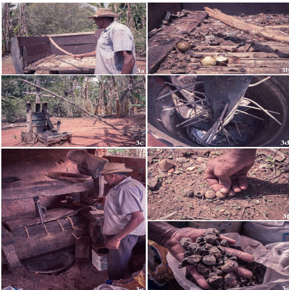
Fig. n.º 3a. Jirau ou batedor de coco usado para quebrar a casca externa do fruto da macaúba; 3b. As cascas externas dos Frutos da macaúba sendo rompidas no jirau com um pedaço de pau; 3c. Maquinário tradicional denominado arranhou e usado pela comunidade local de Jaboticatubas no processo de extração do azeite da polpa da macaúba, destaque para o pau de madeira onde é amarrado um animal, em geral cavalo, para girar em torno do tambor e mover a estrutura metálica do seu interior; 3d. Destaque do interior do tambor do arranhou, com as barras de ferro presas ao eixo do equipamento; 3e. Prensa tradicional. É possível visualizar a bacia abaixo da prensa, onde é recolhido o azeite que escorre dos frutos; 3f. Semente lignificada; 3g. Casca interna (endocarpo) utilizada como carvão de alto poder calorífico.
